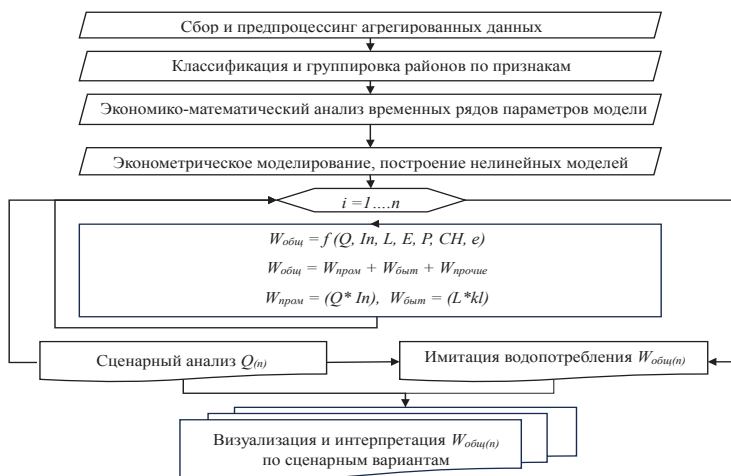
Рис. 2. Блок-схема вычислительного алгоритма оценки и моделирования водопотребления по муниципальным районам Якутии
